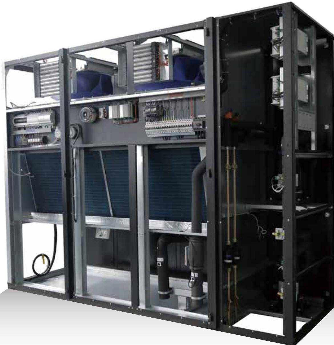
配备DC直流变频器及变频系列机组，可以根据实时热负荷精准调节制冷量，极大地降低了能源的损耗，部分负荷状态下节能效果尤为显著。制冷容量可以在20%~100%的范围内实时调整，把环境温度严格控制在一个极小公差的范围里，并显著降低了运行成本，实现节能最优化。
